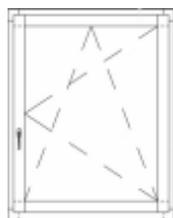
fenêtre basculante et pivotante
